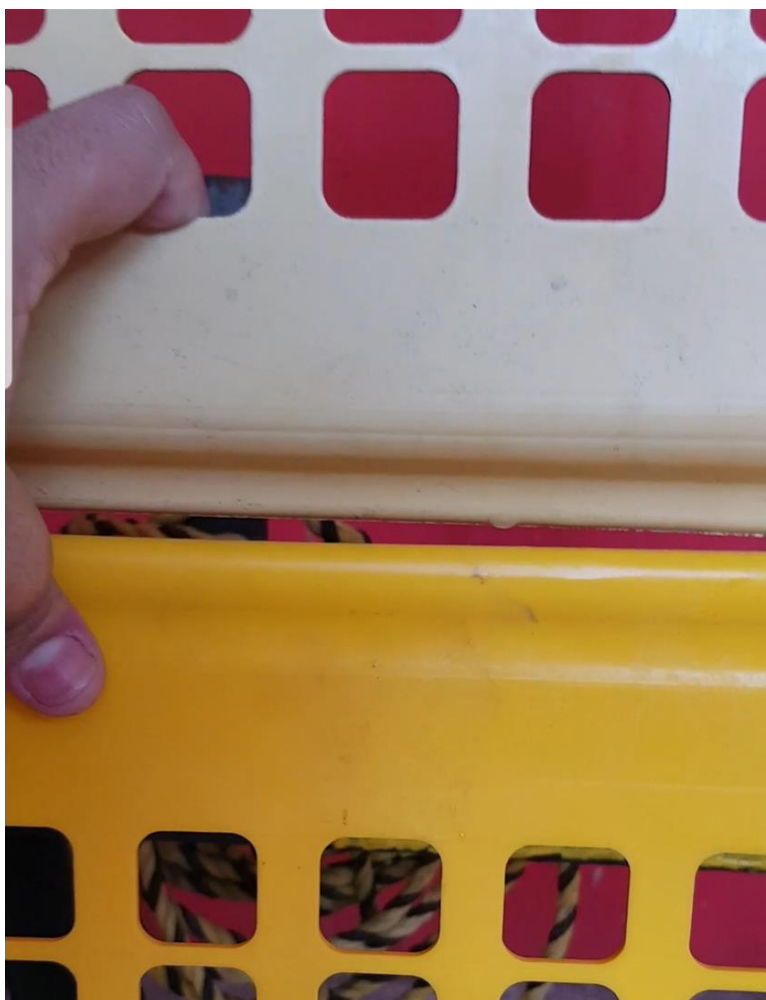
Figura 41 - Grade Superior com cinco anos exposto a intempéries - Grade Inferior 5 anos sem exposição a intempéries
