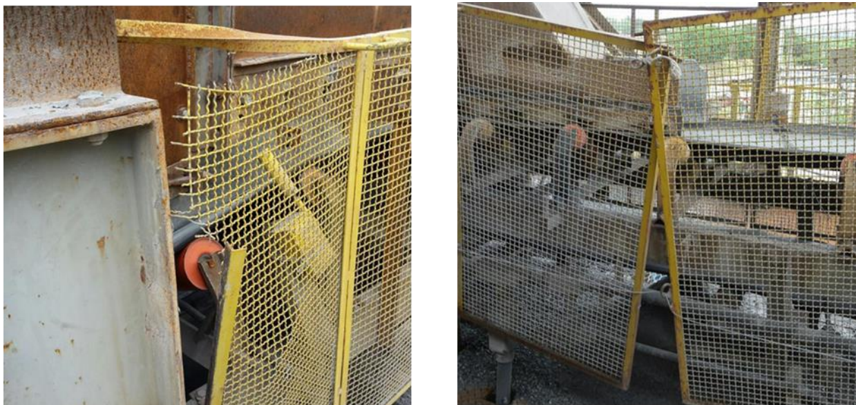
Figura 15 - Proteções Danificadas e oxidadas
