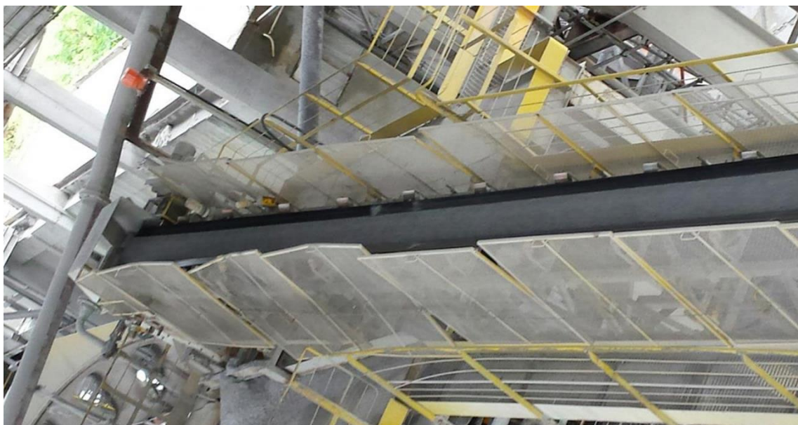
Figura 19 – Proteções metálicas empenadas e amassadas
